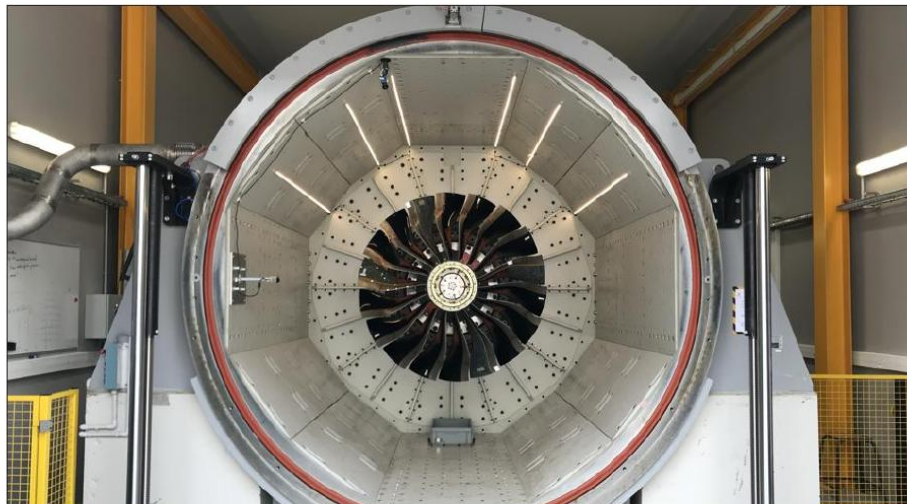
■ Le module de test Phare1 accueille la prototype que l'industriel Safran souhaite tester sous vide. Photo DR
